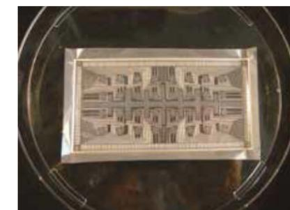
Biocapteurs électroniques imprimés sur membrane
