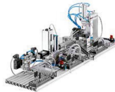
Le module s'appuiera sur du matériel MECLAB tiré du système de formation FESTO. Diverses stations seront mises à votre disposition telles que des bandes de transport, des appareils de manutention et un chargeur-empileur. Dans un premier temps, il s'agira de découvrir l'environnement logiciel et le matériel dans le but de faire fonctionner les stations de façon automatisée. Le module se terminera avec la mise en réseau de ces diverses stations afin de concevoir une ligne de production.
